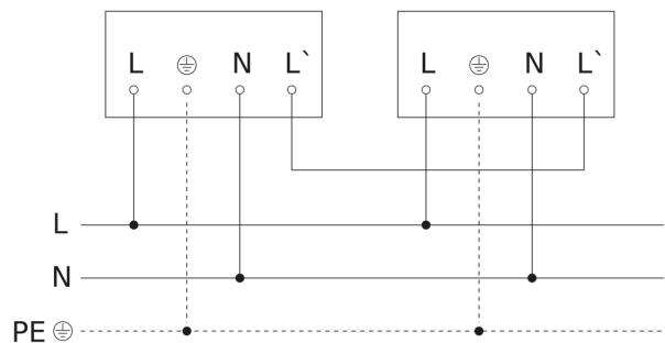
Schéma du circuit d'interconnexion maître/esclave
